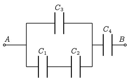
$$\begin{aligned} C_{AB} &= ((C_1 + C_2) \parallel C_3) + C_4 \\ &= \left( \left( (C_1)^{-1} + (C_2)^{-1} \right)^{-1} + C_3 \right)^{-1} + (C_4)^{-1} \\ &= \left( \frac{1}{\frac{1}{C_1} + \frac{1}{C_2}} + C_3 \right)^{-1} + \frac{1}{C_4} \\ &= 1.5 \mu F \end{aligned}$$
