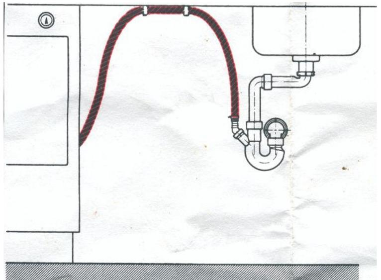
Die Rückschlagklappe wird aufgedrückt, wenn die Abwaschmaschine das Wasser abpumpt. Verhindert jedoch wenn man beim Waschtrog Wasser ablässt, dass das Wasser zurück in die Maschine läuft.
