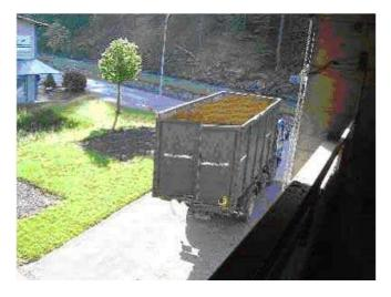
Die Holzschnitzel werden direkt vom Container-Lastwagen in die Abladegrube des Silos entleert.
