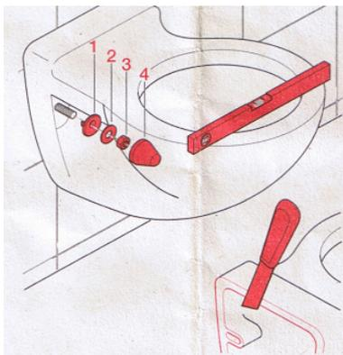
Je nach Anforderungen wird ein Schallschutzset oder Schnellzement hinter das WC getan, bevor man es montiert.
