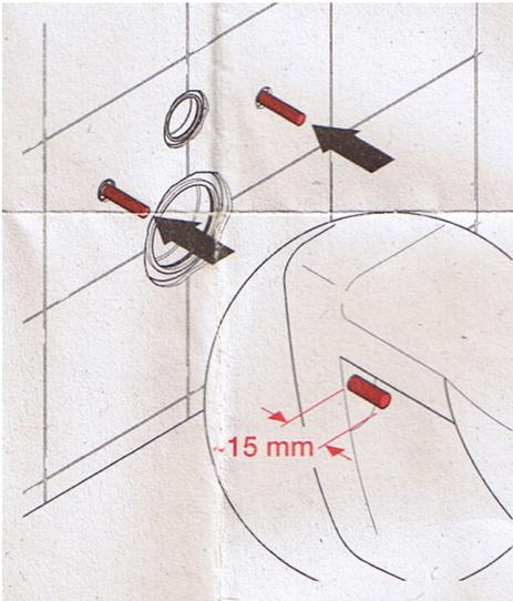
7. Die zwei Stützen werden eingesteckt.
