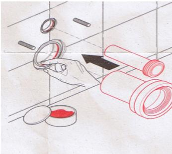
8. Die Muttern, die Unterlagsscheiben und das Werkzeug legt man am besten schon zurecht bevor das WC montiert wird. Die WC-Schüssel kann man dann am besten montieren wenn sie auf den Oberschenkeln aufliegt. Das WC wird angezogen aber nicht zu fest sonst geht sie kaputt. Ich mache immer den Rüttel-Test je nach dem muss man noch ein bisschen nachziehen. Wichtig ist natürlich dass das WC in blei ist.
