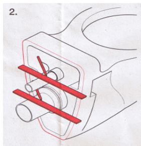
4. Die Masse zwischen den Strichen werden noch 3 mm dazu gerechnet und dann so abgeschnitten.
