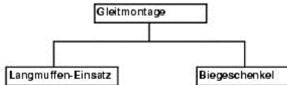
**Grundsatz:** Die thermisch bedingte Längenänderung muss durch die Art der Befestigung (Fixpunkt und Gleitschelle) auf Langmuffe, Dehnungselement oder Biegeschenkel gesteuert werden.
