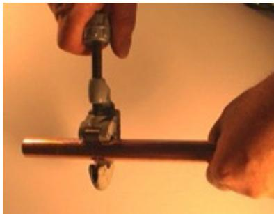
1. Kupfer- oder Edelstahlrohr mit einem Rohrabschneider ablängen.
