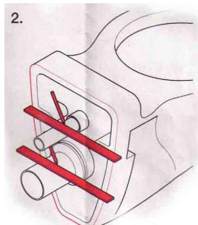
Um keine Spannung aufs WC zu Erzeugen, Keramikmasse oder Schallschutzset hinten auf an WC streichen.
