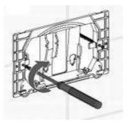
4. Die beiden und Drückerstangen auf die richtige Länge kürzen, einschieben und sie arretieren.
