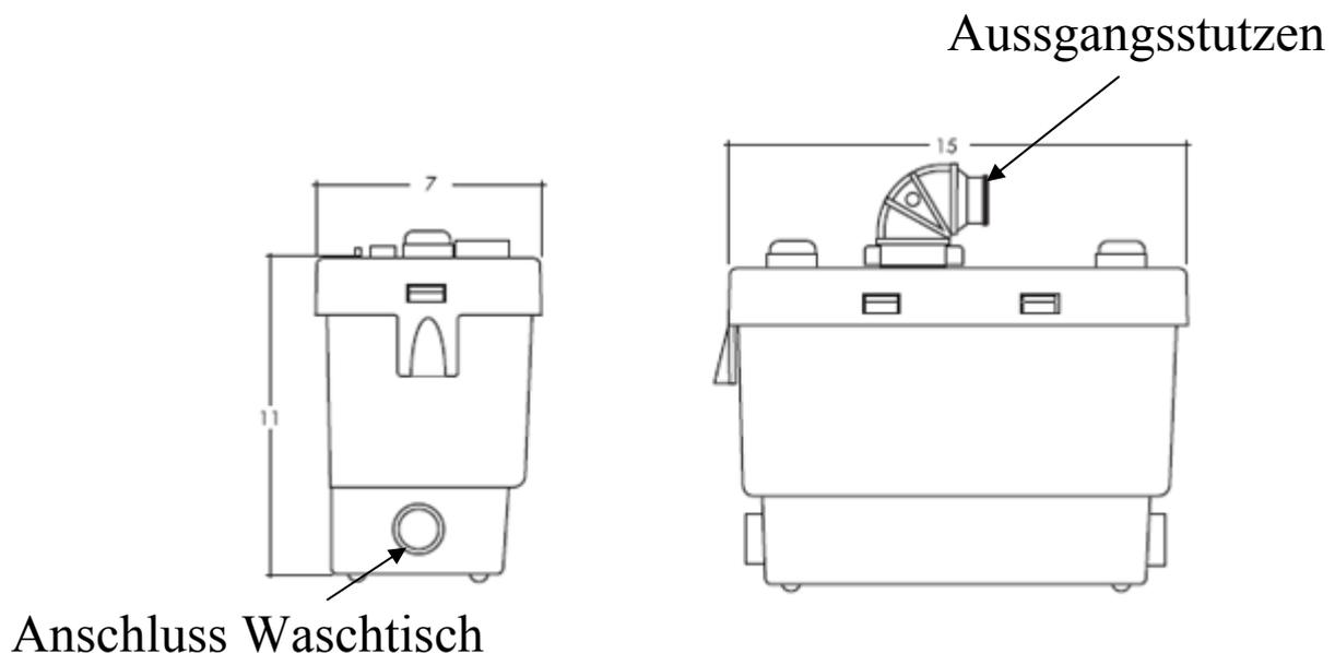
Sie funktioniert so: Eingespülte Fäkalien und Toilettenpapier werden durch ein Edelstahl- Schneidewerk zerkleinert, mit dem Spülwasser gemischt und dann als flüssige Brühe weggepumpt.
