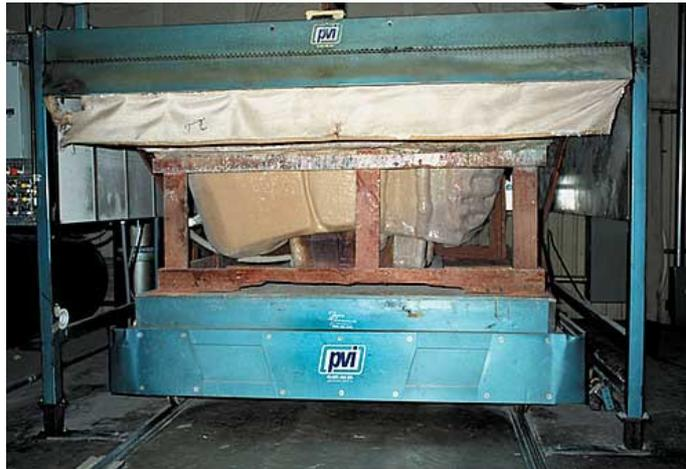
Zuerst wird die Acrylplatte in einem Ofen auf eine gewisse Temperatur erwärmt, danach kommt sie in eine Tiefziehmaschine, welche mit Unterdruck die Acrylplatte in eine Form saugt.
