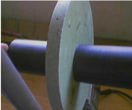
2. Rohr erwärmen bis eine Wulst von  $\frac{1}{3}$  Wandstärke entstanden ist.
