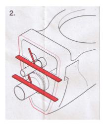
4. Die Masse zwischen den Strichen werden noch 3 mm (Schallschutzset) dazu gerechnet und dann so abgeschnitten.
