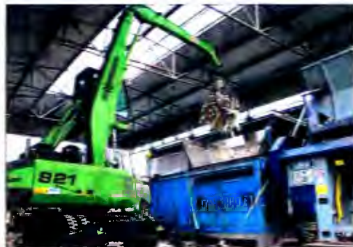
Nach der Anlieferung der Abfälle werden diese in die automatische Sortierung gegeben und dort nach unterschiedlichen Qualitäten getrennt. Folien (rechts oben) werden dem Recycling zugeführt. Fotos: Pöschus
