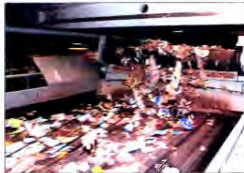
Nach der Anlieferung der Abfälle werden diese in die automatische Sortierung gegeben und dort nach unterschiedlichen Qualitäten getrennt. Folien (rechts oben) werden dem Recycling zugeführt. Fotos: Pöschus
