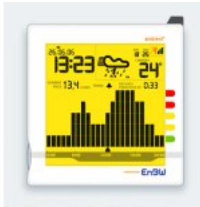
Mit Hilfe eines kleinen Geräts werden sich Privatkunden bei ihrem Stromverbrauch nach dem angezeigten Tarif richten können – eine Revolution an der Steckdose. Ermöglicht durch die dynamisch aktualisierte Übertragung der Daten über das bundesweite Paging-Netz von e\*Message.
