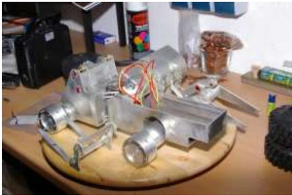
Für das Chassis ist ein ähnlicher Rahmenbau gewählt worden wie der von der Firma CTI, so dass auf jeden Fall die Hubzylinder dieser Firma verwendet werden können und werden. Bei dem Chassis ist es so, dass das Grundmaterial aus Aluminium besteht. Dadurch bekommt das Unterteil sein benötigtes Eigengewicht und auch eine gewisse „Steifigkeit“. Auch die Ladeschaufel ist aus Aluminium. Mit dabei ist
