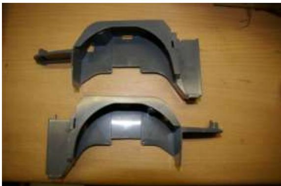
Auch hier wurden Löcher für die Verschraubung nach der Lackierung angebracht und auch diese wurden auf das Fahrgestell übertragen.
