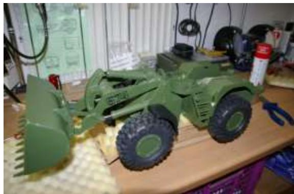
Das auf diesem Bild eingesetzte Unterteil der Fahrerkabine ist nur zur „Sitzprobe“ aufgesetzt worden. Dies wird später zusammen nach dem Einbau und Anschluss der Beleuchtung erst aufgesetzt. Quasi als letzten Stepp ... In das Heckteil sind die Rückleuchten sowie auch die Blinker bereits eingebaut. Entgegen dem Original aber an einer anderen Position 😊. Dafür aber einfacher zu verkabeln und anzuschließen 😊.
