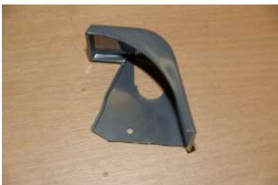
Als nächstes wurden dann die Löcher für die Verschraubungen gebohrt, um dann, entgegen der vorgeschlagenen Weise, bei der Montage die Schutzbleche anschrauben zu können. Nach der Lackierung können so die Abdeckungen angeschraubt werden. Normalerweise sollten die Abdeckungen verklebt werden.
