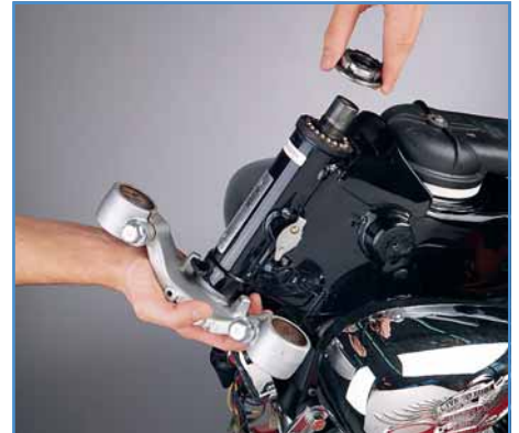
3. Gabelbrücke nach unten herausziehen
