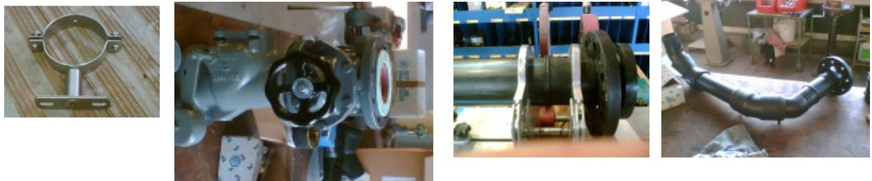
Das Druck-Pe wird auf einer speziellen Schweissmaschine geschweisst
