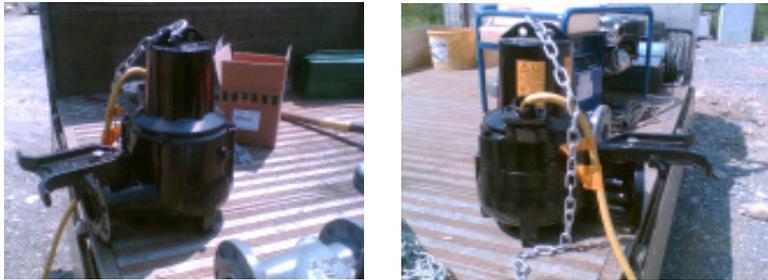
Nun kann die Pumpe ins Regenbecken runter lassen, dabei dienen die zwei Rohre als Führung. Die Pumpe wird nicht am Sockel angeschraubt, denn am Sockel ist eine Dichtung angebracht und durch das Gewicht der Pumpe dichtet es ab.
