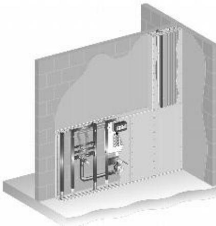
Bild 13: Duofix System Vorwandinstallation
