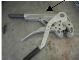
Hydraulikaggregat wird gebraucht zum Biegen und zum aufweiten
