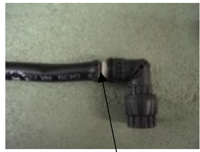
Falsch der O-Ring ist sichtbar
