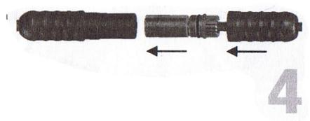
Die Klemmschneidhülse gegen die Hülse schieben und dann in die entsprechende Gehäuse einführen. Darauf achten das die Nut der Verdrehsicherung deckungsgleich sind. Gewindekappe und das Gehäuse bis auf den Anschlag zusammendrehen.
