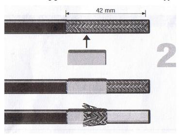
Die Schutzhülle der Heizleitung auf 42 mm entfernen. Das Klemmblech über die metallene Umhüllung (Geflecht) auf Anschlag zur Schutzhülle schieben. Das Geflecht wird dann über das Klemmblech gestülpt.
