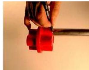
5. Fitting vor dem Einstecken innen auf Sauberkeit und korrekten Sitz des O-Ringes optisch überprüfen. Rohr unter leichtem Drehen einstecken, bis es den Anschlag bzw. die Markierung erreicht hat.
