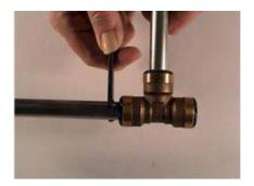
2. Roten Kunststoffring der jeweiligen Dimension (mit Konus gegen den Fitting) zwischen Fitting und gelöster Kunststoff-Hülse über das Rohr stülpen.
