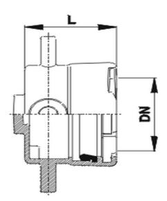
Verwendungsbereich Trinkwasser, Abwasser: max. 16 bar Betriebsdruck.
