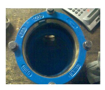
Dies ist ein Bild von einer Endkappe für PE- Rohr. Der Messingring hat eine Oberflächenstrucktur die geräubelt ist. Das verhindert das abrutschen bei hohem Druck. Man kann die Endkappe auch als Provisorium nützen.
