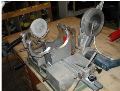
3. Formstücke oder Rohre winkelrecht mit einem Rohrabschneider abschneiden.
