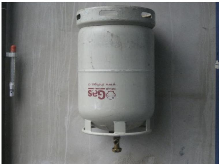
2. Die Vorrats und Kleine Flasche mit metallendem Umfüllrohr verbinden (Linksgewinde). Überwurfmutter mit Schlüssel gut anziehen.
