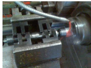
Die Gewindeschneidmaschine hat zwei Gänge. Wenn man Rohre schneiden will die über 1 Zoll sind kann man den schnellen Gang einlegen. Bei Rohren die grösser als 1 Zoll sind muss der zweite Gang eingelegt werden, damit es ein schönes Gewinde gibt.
