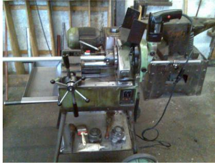
Mit einer Gewindeschneidmaschine kann man ein Gewinde auf das Rohr schneiden. Zuerst spannt man das Rohr in den Schraubstock und zieht es fest an, damit es während des Gewindeschneidens nicht dreht.
