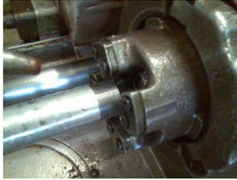
Das Gewinde ist nun geschnitten. Jetzt klappt man die Backe hoch und schiebt den Schraubstock nach hinten damit das Rohr zugeschnitten werden kann.
