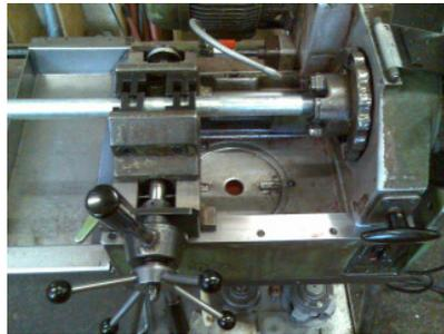
Nun spannt man die Backe damit das Gewinde geschnitten werden kann. Nach jedem Vorgang muss man die Backe erneut spannen, weil sie sich immer automatisch löst wenn das Gewinde geschnitten ist.
